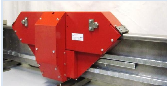
Messwagen auf Mess-Schiene mit Zahnstange
