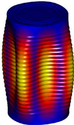
Stabilitätsuntersuchung: Konservendose unter Vakuum, 3D
