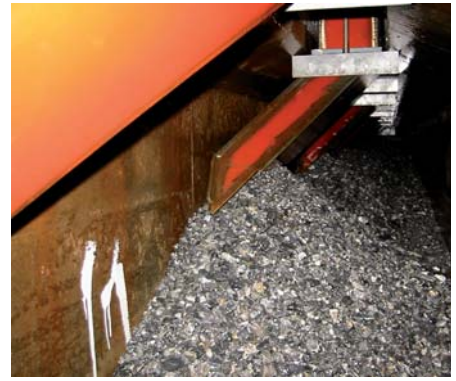
Bild 6. Typischer Füllgrad von Spülrohr oder Spülkanal.
