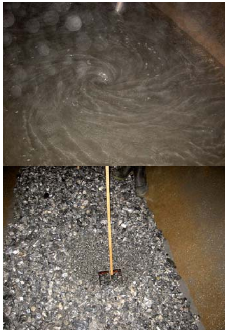
Bild 7. Typischer Wirbel über den Abzugsöffnungen.
