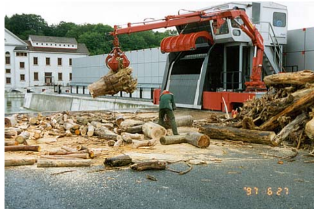
Abb. 4 Gesamtanlage Rechenreinigung mit anspruchsvollen Zusatzanforderungen
